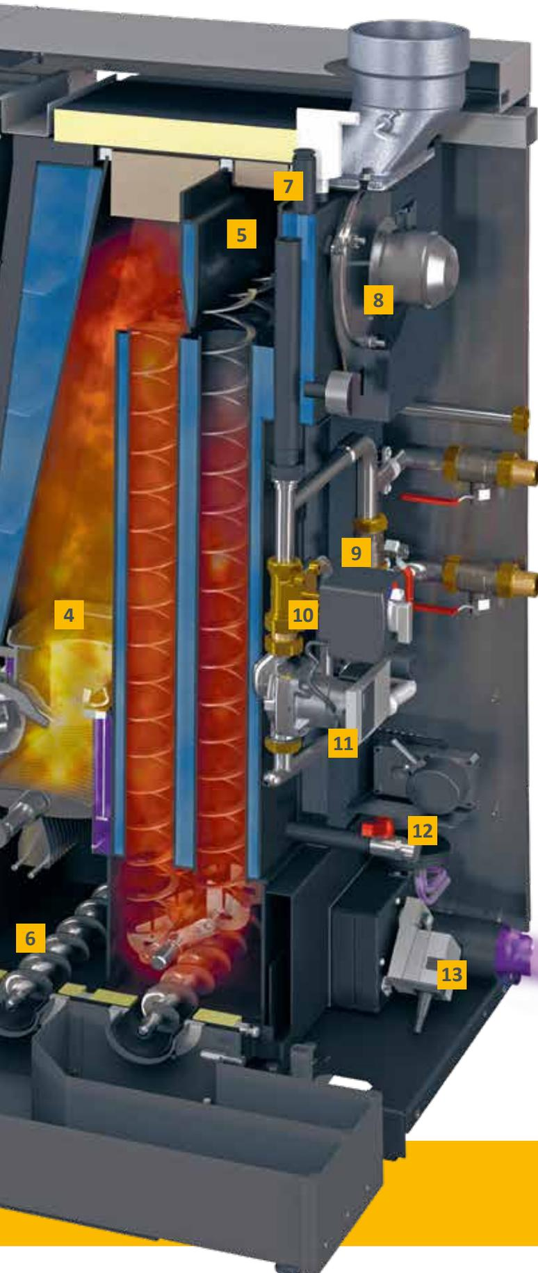
**7 Soupape de sécurité** : Une soupape de sécurité et un capteur électronique de pression protègent la chaudière de toute surpression. Un purgeur d'air automatique est également intégré pour éliminer l'air indésirable du circuit d'eau de chauffage. La chaudière n'a pas besoin d'une soupape thermique, car la chaudière ne contient pas beaucoup de combustible et qu'une surchauffe est fortement improbable.
