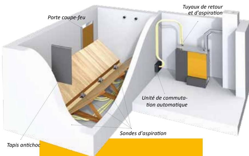
Les sondes d'aspiration permettent d'installer un silo à pellets dans quasiment toutes les pièces, même si celles-ci sont difficiles d'accès ou présentent des angles. Pour les silos de grande longueur, on peut installer jusqu'à 8 sondes.
